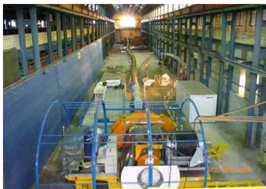
Essai de mise en alvéole/retrait de colis HA
